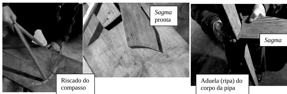
Pic. 1. Construção da sagma para alinhamento das aduelas
