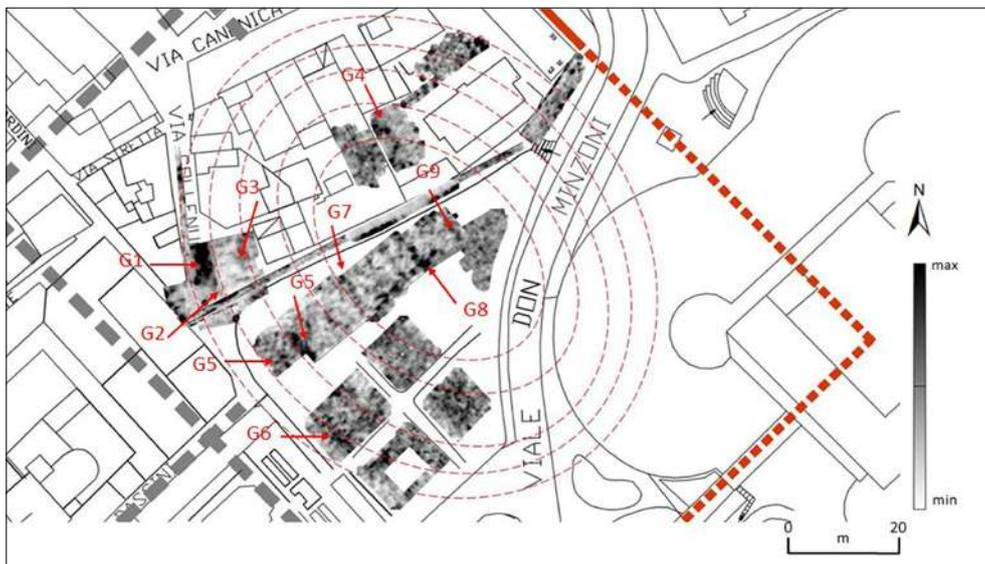
Fig. 8. GPR *time-slices* nel range di profondità stimata 4-5,5 m dalla superficie. Le frecce indicano alcune anomalie dovute alla presenza di riflettori disposti con un andamento coerente con l'ipotesi di ubicazione della struttura dell'anfiteatro o con strutture ad esso pertinenti.
