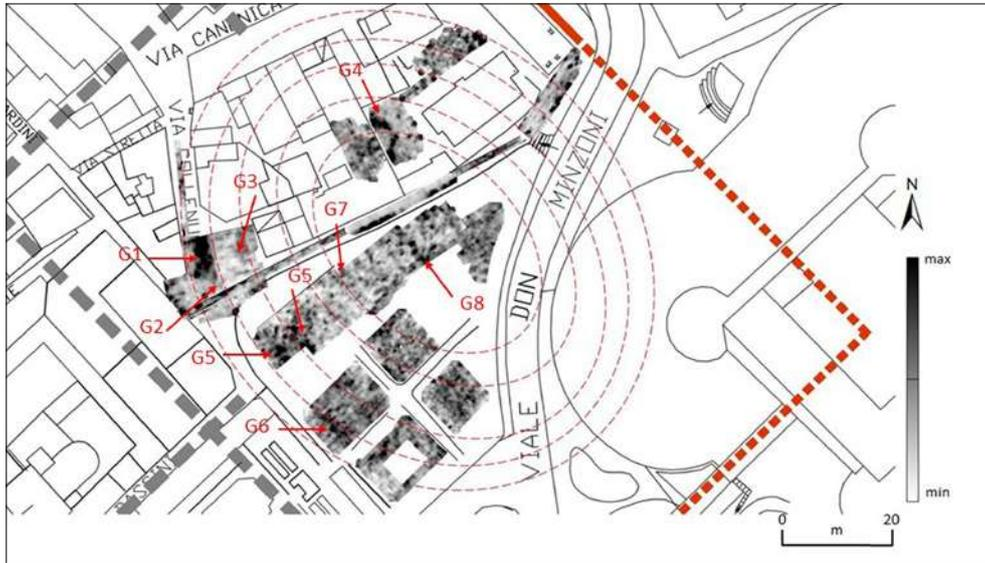
Fig. 7. GPR *time-slices* nel range di profondità stimata 3-4 m dalla superficie. Le frecce indicano alcune anomalie dovute alla presenza di riflettori disposti con un andamento coerente con l'ipotesi di ubicazione della struttura dell'anfiteatro. Le linee tratteggiate in grigio scuro indicano la direzione della viabilità di epoca romana; mentre le linee tratteggiate in rosso rappresentano l'andamento delle mura romane.
