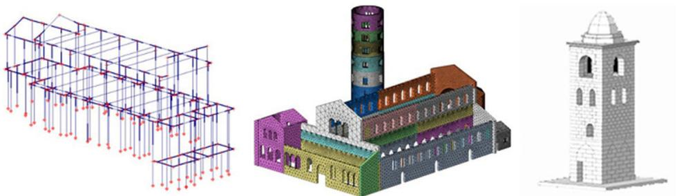
Fig. 9. Modelli per il comportamento meccanico delle pareti murarie: a) modello a telaio equivalente dell'ex chiesa di San Francesco ad Alto, Ancona; b) modello FEM con elementi solidi della Basilica di Sant'Apollinare in classe, Ravenna; c) modello DEM della torre campanaria del Duomo di San Ciriaco, Ancona
