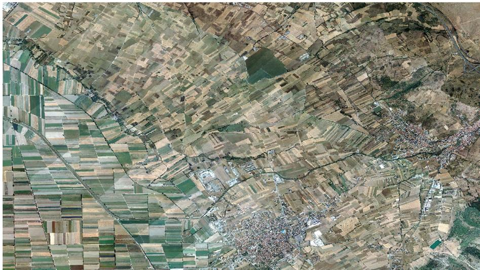
Fig. 3. La conca del Fucino tra i paesi di Pescina e San Benedetto dei Marsi (ortofoto 2007). Sono evidenti la geometria delle particelle nell'area agricola bonificata, la struttura della rete idrica, gli abitati pedemontani e i differenti assetti parcellari connessi
